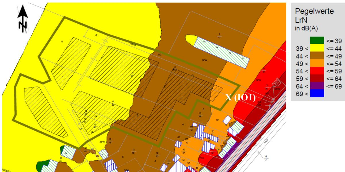
Man sieht, dass an der Ostseite des nordöstlichen Baufeldes die Grenzwerte leicht überschritten sind. Dies wurde mit dem IO 1 in **Tabelle 2** dokumentiert.
